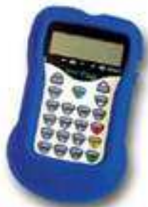
smarTach D-BOX pour le téléchargement des données
